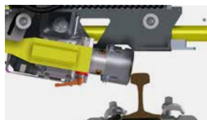
Plage de pivotement maximale 32° extérieur et 80° intérieur
