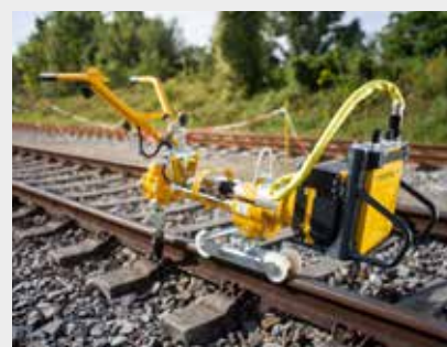
ROWRENCH 30.82HKS E³ Máquina clavadora universal a batería
