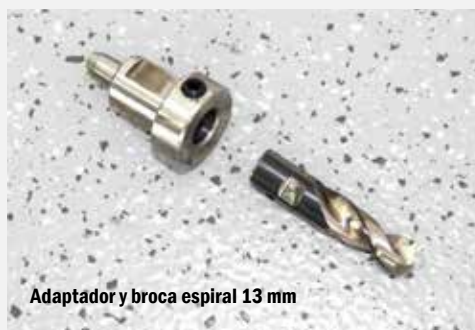
Broca, adaptador y perno de expulsión/refrigeración
