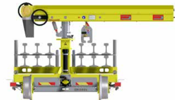
Schéma de chargement avec max. 12 unités de rails sur deux niveaux
