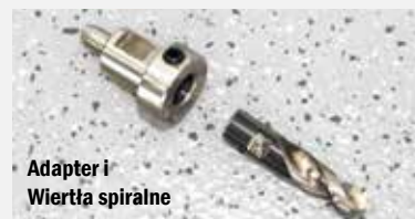
Wiertło, adapter i sztyft wypychacza chłodziwa
