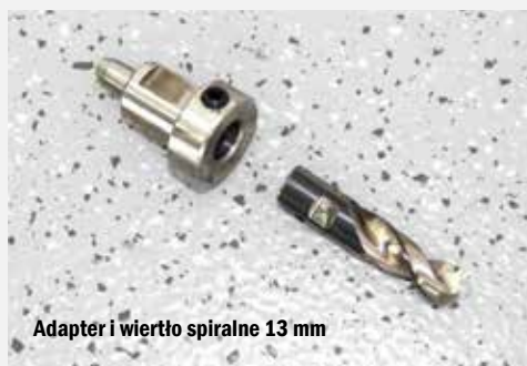
Wiertło, adapter i sztyft wypychacza chłodziwa
