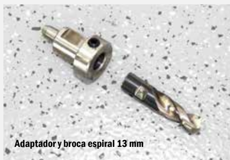
Broca, adaptador y perno de expulsión/refrigeración
