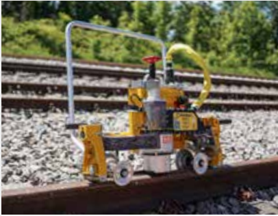
ROGRIND 13.45MD E³ Schweißstoß-Schleifmaschine
