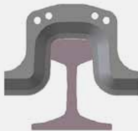
Cuchilla de desbarbado FORMA A (con subida)
