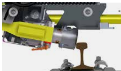
Plage de pivotement maximale 32° extérieur et 80° intérieur
