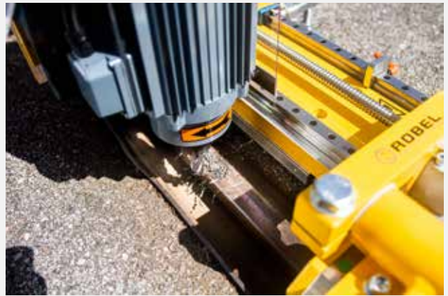
Entwässerungsnut mit ROFACE Schienenfräse
