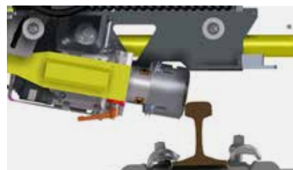
Plage de pivotement maximale 32° extérieur et 80° intérieur
