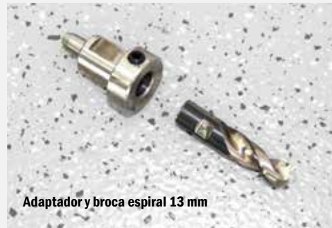
Broca, adaptador y perno de expulsión/refrigeración
