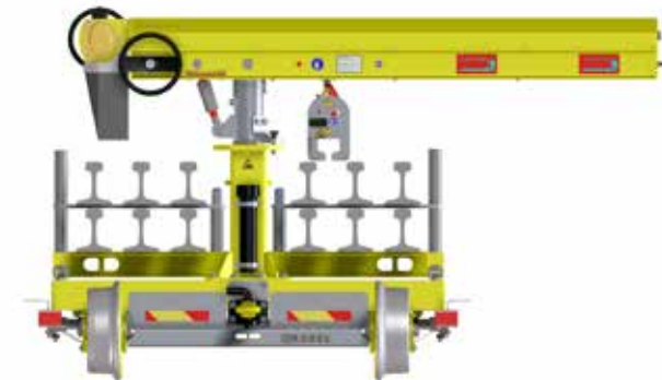
Esquema de carga con máx. 12 carriles en dos niveles
