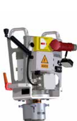
Módulo muela de copa motor eléctrico
