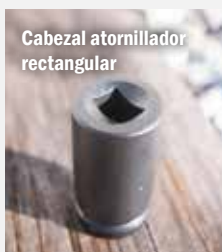
Cabezal atornillador cuadrado
