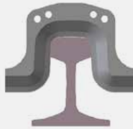
Cuchilla de desbarbado FORMA A (con subida)
