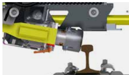
Maximaler Schwenkbereich 32° außen und 80° innen
