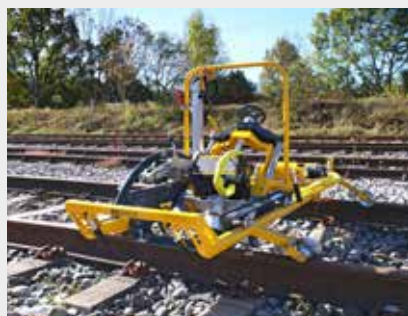
ROGRIND 13.63 Modulare Schienen- u. Weichenschleifmaschine
