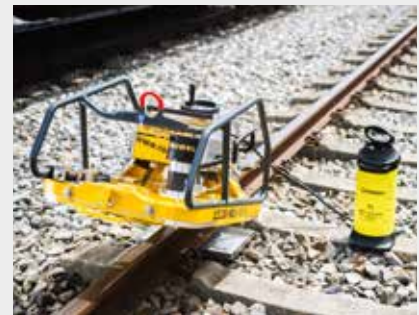
ROSAW 12.20MSB E 3 Akku-Schienenbandsäge
