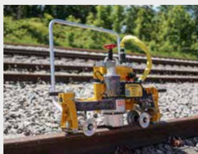
ROGRIND 13.45MD E³ Schweißstoß-Schleifmaschine
