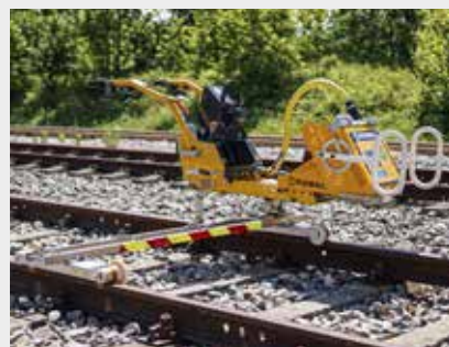
ROWRENCH 30.76 E³ Vollelektrische Präzisions-Schraubmaschine
