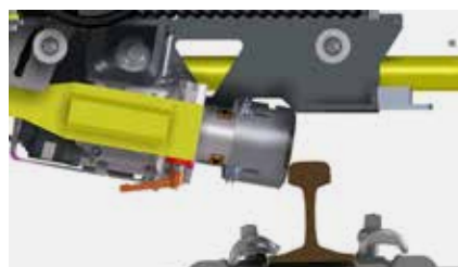
Maximaler Schwenkbereich 32° außen und 80° innen
