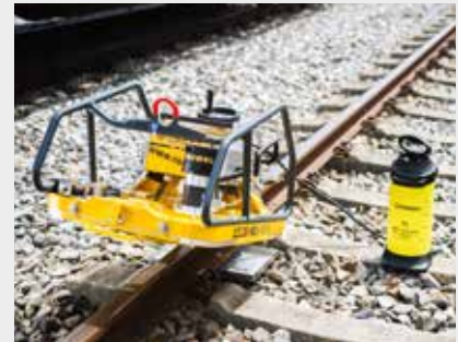
ROSAW 12.20MSB E 3 Akku-Schienenbandsäge
