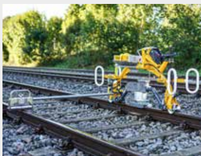
ROGRIND 13.49 E³ Hybrid-Schienenkopf-Konturschleifmaschine
