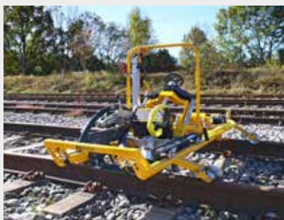
ROGRIND 13.63 Modulare Schienen- u. Weichenschleifmaschine
