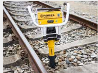
ROTAMP 62.20L E 3 Akku-Vertikal-Schwingstopfer
