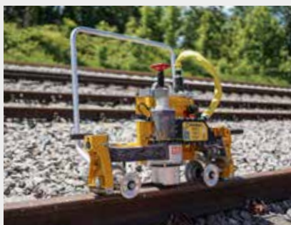
ROGRIND 13.45MD E³ Schweißstoß-Schleifmaschine
