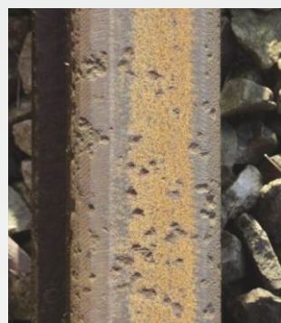
Ausbröckelungen auf dem Gleis und das Abbild im Messprogramm
