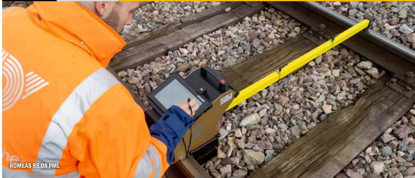
**Zur laserbasierten Erfassung des Schienenquerprofils von Vignolschienen und optional Rillenschienen nach Schleif- oder Fräsarbeiten.**
