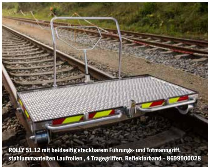
ROLLY 51.12 mit beidseitig steckbarem Führungs- und Totmanngriff, stahlummantelten Laufrollen, 4 Tragegriffen, Reflektorband - 8699900028
