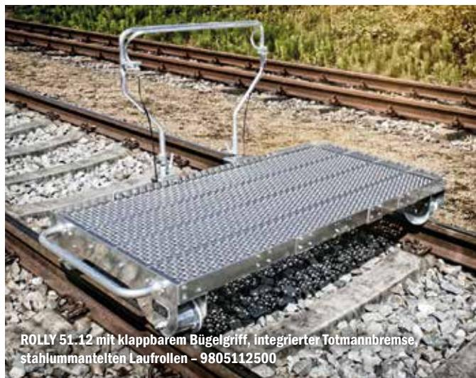
ROLLY 51.12 mit klappbarem Bügelgriff, integrierter Totmannbremse, stahlummantelten Laufrollen - 9805112500
