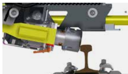
Maximaler Schwenkbereich 32° außen und 80° innen
