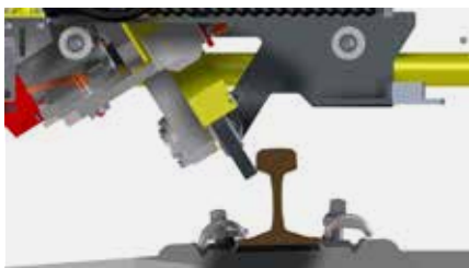
Maximaler Schwenkbereich: 32° in beide Richtungen mit Modul Schleifscheibe
