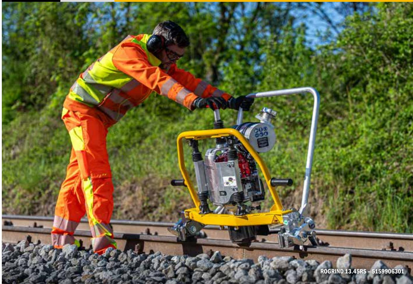
**Zum präzisen Schleifen von Schweißstößen und zur Reprofilierung des vollständigen Schienenkopfes. Einsatz auch im Weichenbereich, zum Herzstück schleifen und für Rillenschienen möglich.**
