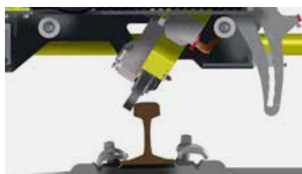
Modul Schleifscheibe GX 270
