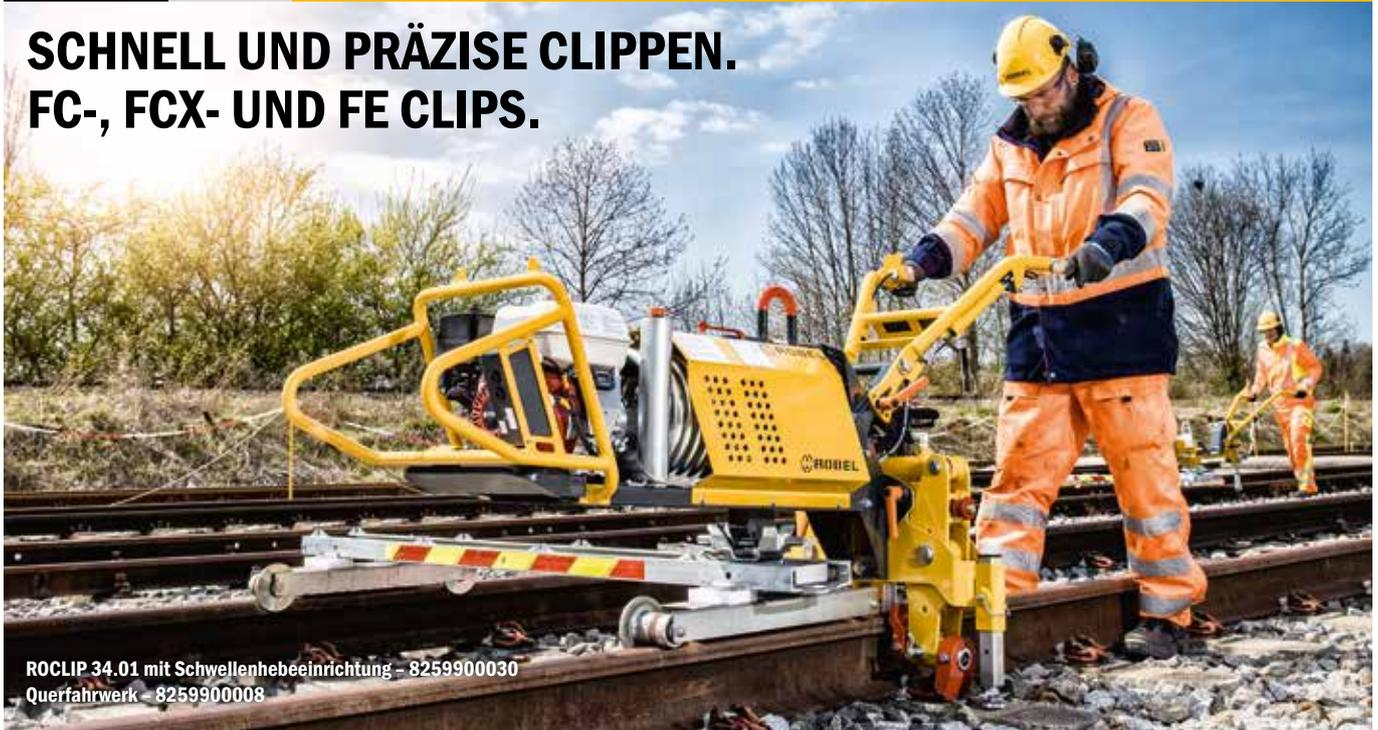
ROCLIP 34.01 mit Schwellenhebeeinrichtung - 8259900030
