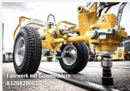
Fahrwerk mit Gummirädern
