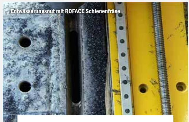
Entwässerungsnut mit ROFACE Schienenfräse
