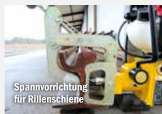
Spannvorrichtung für Rillenschiene
