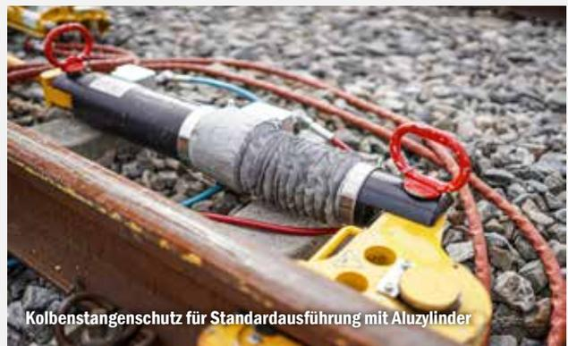
Kolbenstangenschutz für Standardausführung mit Aluzylinder
