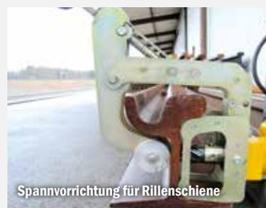
Spannvorrichtung für Rillenschiene
