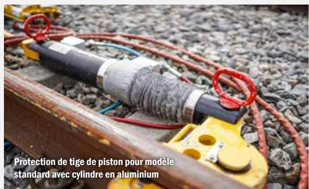
Protection de tige de piston pour modèle standard avec cylindre en aluminium
