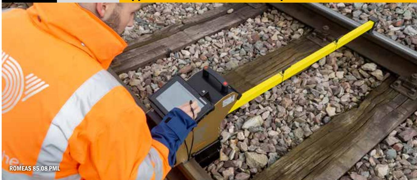
**Pour relever au laser le profil transversal des rails Vignol et en option des rails à gorge après les travaux de meulage et de fraisage.**
