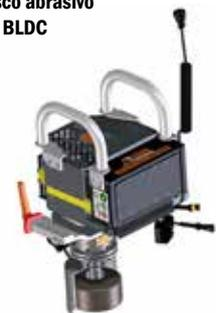
Módulo E3 esmerilado del alma del carril Motor eléctrico BLDC
