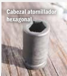
Cabezal atornillador hexagonal
