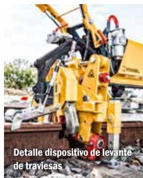
Detalle dispositivo de levante de traviesas
