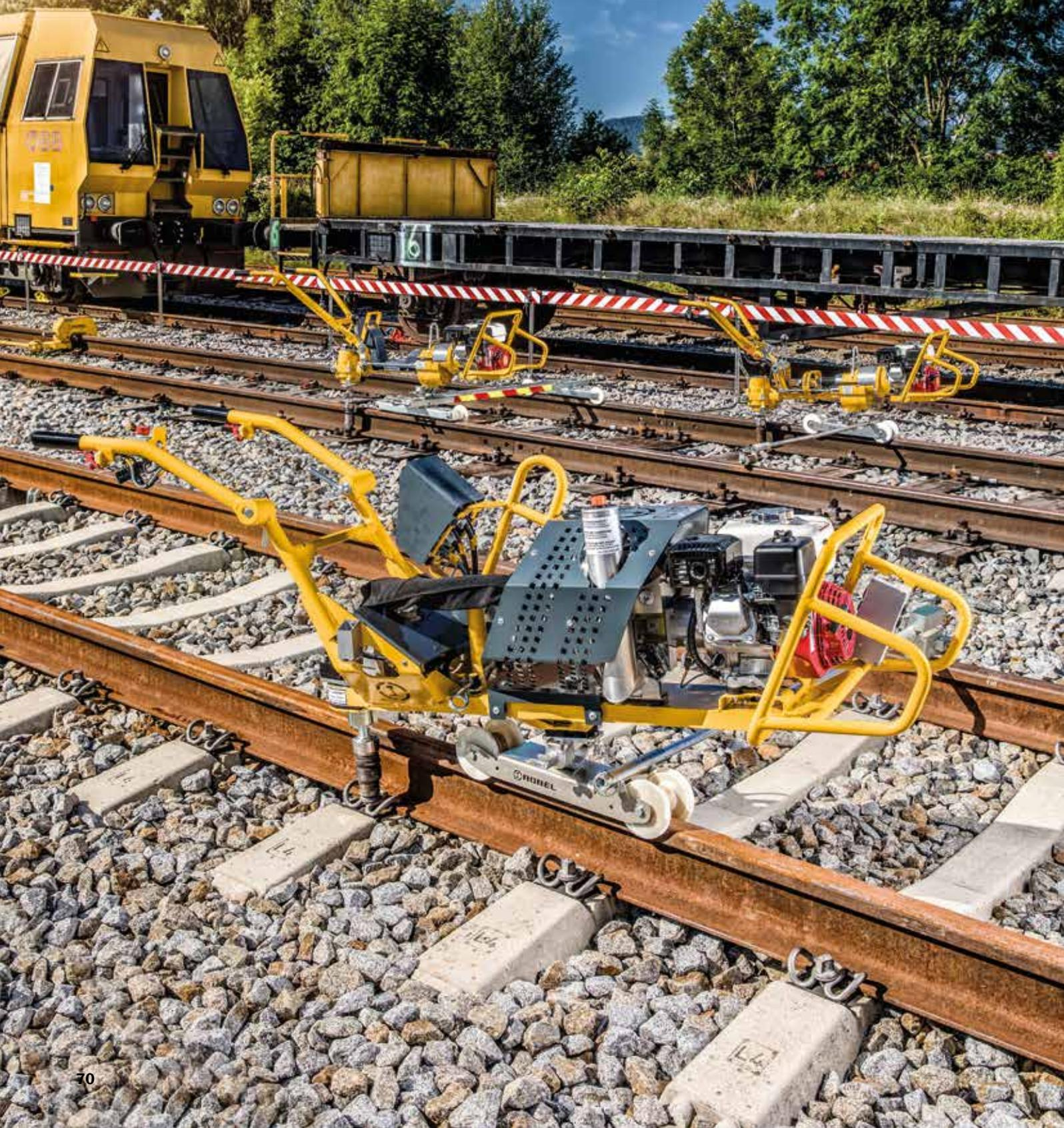
Para atornillar y desatornillar tuercas, tirafondos y tornillos de gancho.
