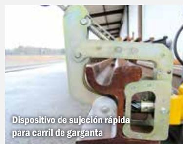
Dispositivo de sujeción rápida para carril de garganta
