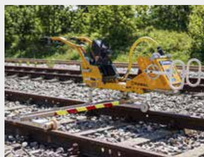
ROWRENCH 30.76 E³ Awitatrice di precisione completamente elettrica
