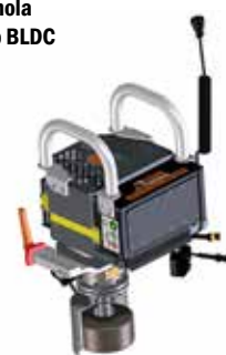
Modulo E3 molatura del gambo della rotaia Motore elettrico BLDC
