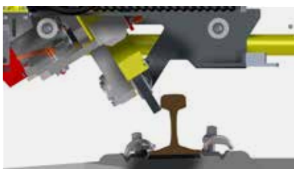
Raggio di azione max.: 32° in entrambe le direzioni con modulo della mola
