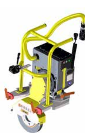
Module E³ meule Moteur BLDC électrique
