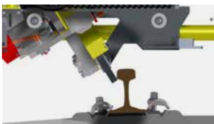
Plage de pivotement maximale : 32° dans les deux sens avec meule
