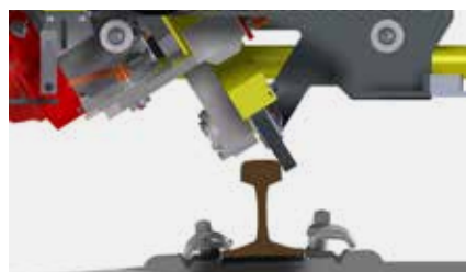
Plage de pivotement maximale : 32° dans les deux sens avec meule
