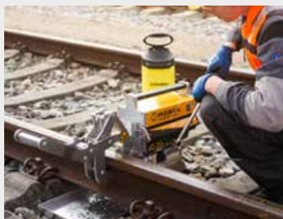
RODRILL 10.20 E 3 Perceuse de rail sur batterie
