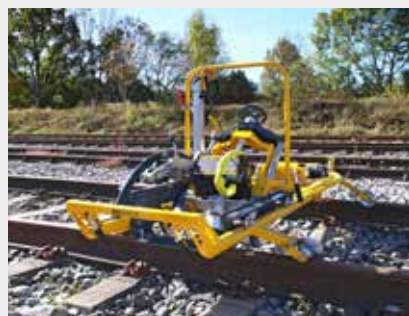
ROGRIND 13.63 Meuleuse modulaire pour rail et appareils de voie
