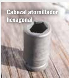
Cabezal atornillador hexagonal
