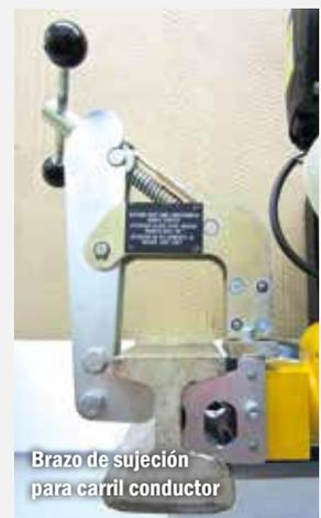
Brazo de sujeción para carril conductor
