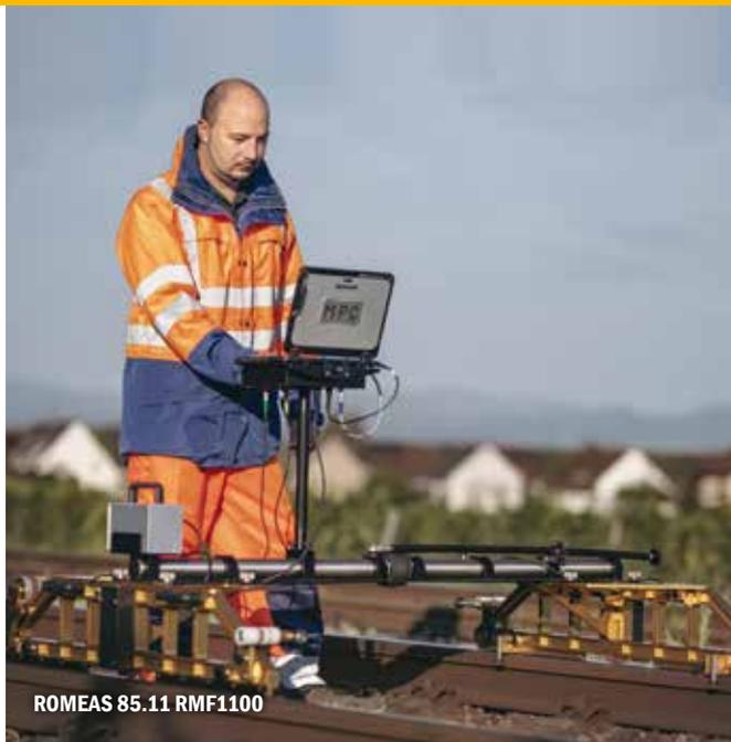
Para registrar de forma automática la calidad de la superficie de rodadura (tramo de medición = 150 mm) antes después de trabajos de esmerilado o fresado.
