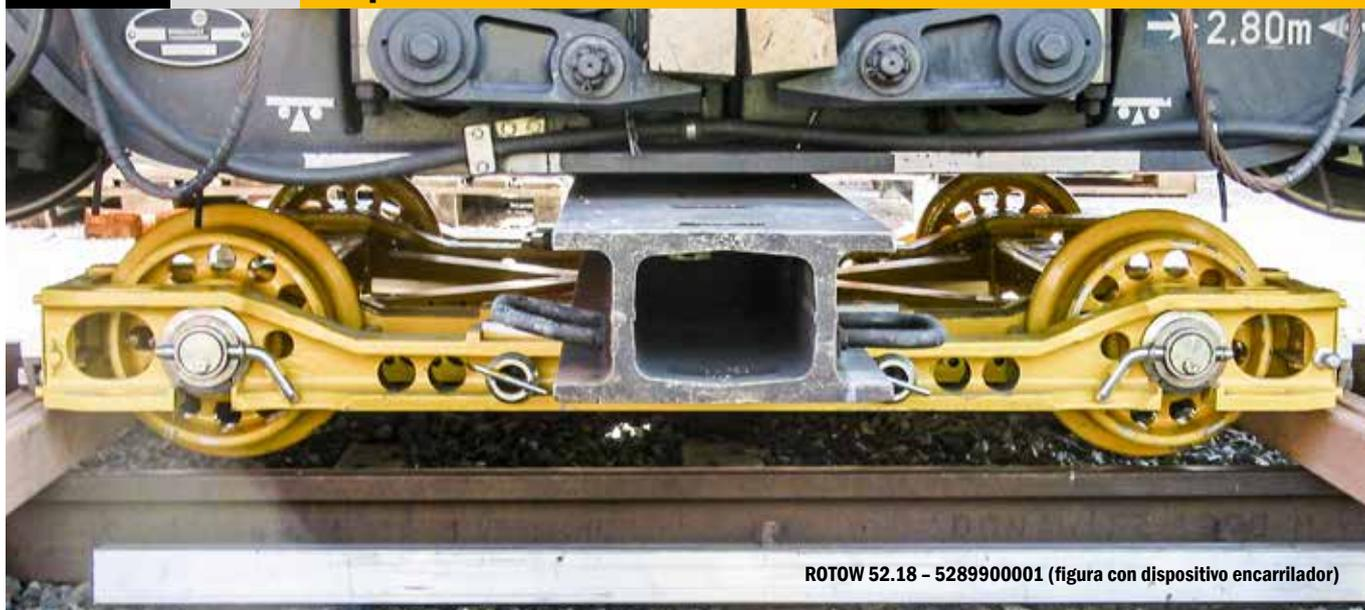
**Para la retirada y el transporte de vehículos ferroviarios con ruedas o pares de ruedas averiados.**
