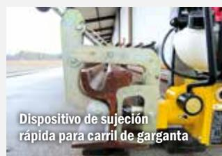
Dispositivo de sujeción rápida para carril de garganta
