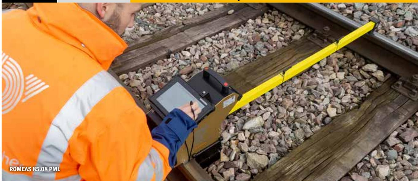
**Para detectar por láser el perfil transversal del carril Vignole y opcionalmente del carril de garganta tras los trabajos de esmerilado o fresado.**
