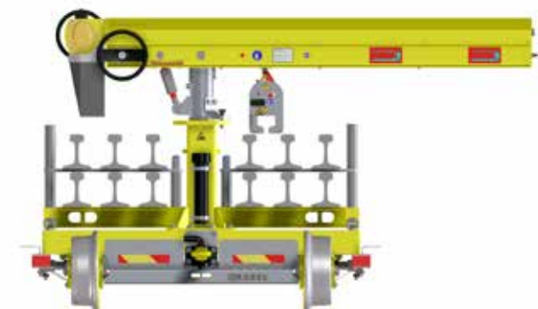
Schema di carico con max. 16 pezzi di rotaie su due piani
