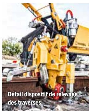
Détail dispositif de relevage des traverses
