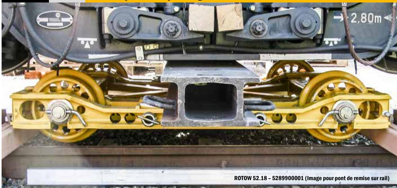
**Pour dégager et transporter des véhicules ferroviaires avec roues ou essieux défectueux.**
