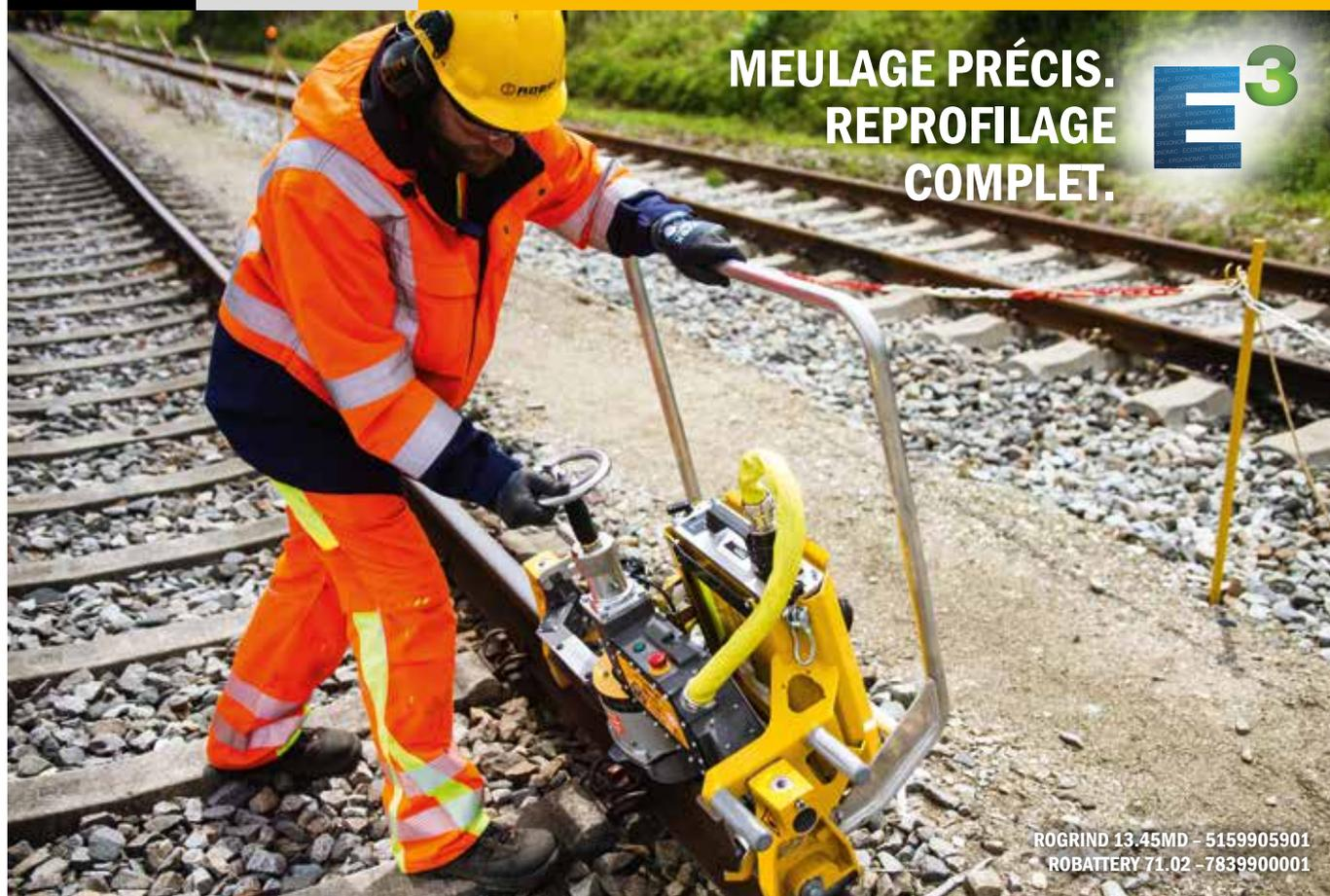
**Pour meuler les soudures et reprofiler entièrement le champignon de rail. Utilisation possible également en zone d'appareil de voie et pour meuler les rails à gorge et les rails de grue.**
