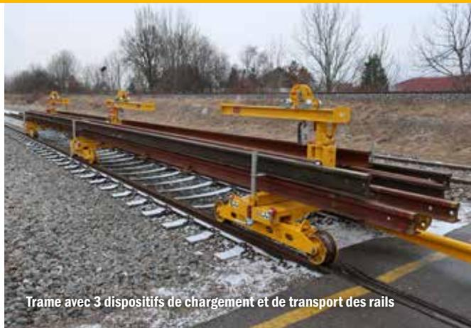
Trame avec 3 dispositifs de chargement et de transport des rails
