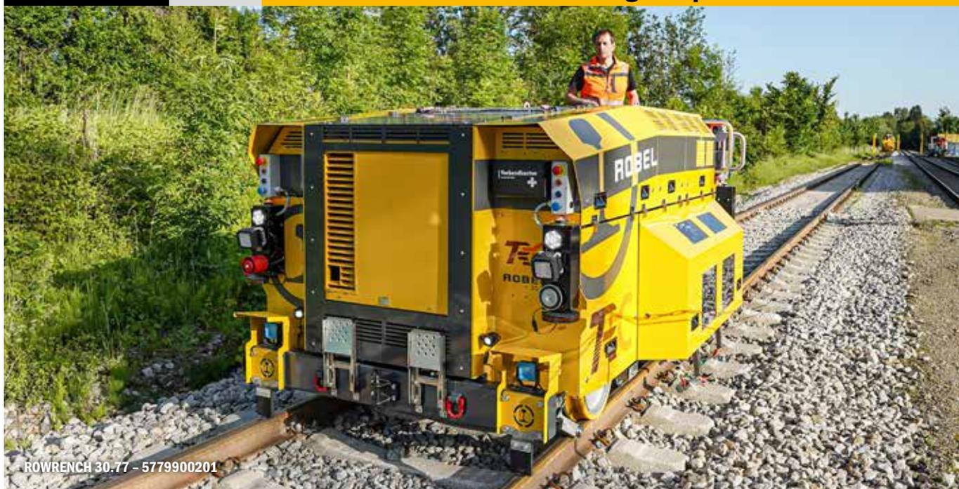
**Pour serrer ou desserrer simultanément jusqu'à 8 fixations à vis en une passe.**
