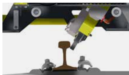
Módulo muela de copa motor eléctrico
