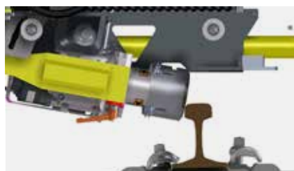
Maximaler Schwenkbereich 32° außen und 80° innen
