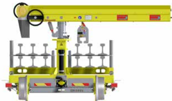
Beladungsschema mit max. 12 Stück Schienen auf zwei Etagen
