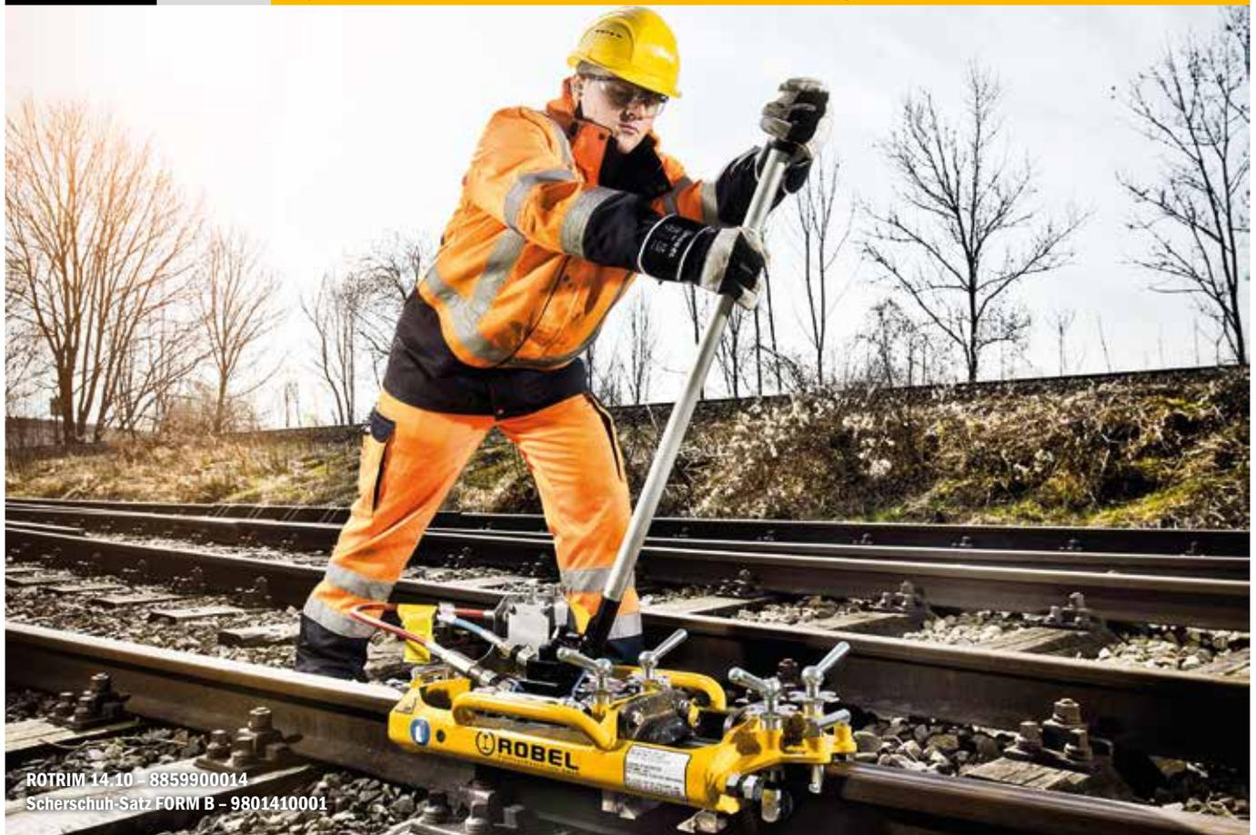
**Zum Abscheren von alumino-thermischen Schienenschweißungen.**
