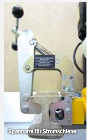
Spannarm für Stromschiene
