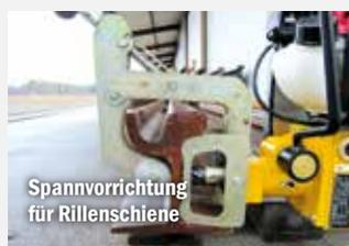
Spannvorrichtung für Rillenschiene
