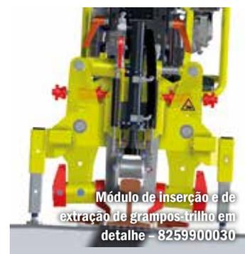
Módulo de inserção e de extração de grampos-trilho em detalhe - 8259900030
