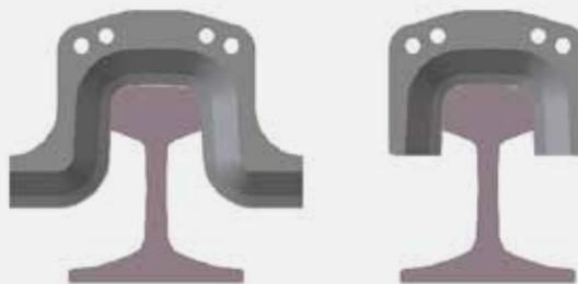
Sapata de cisalhamento **FORMA A**      Sapata de cisalhamento **FORMA B**
