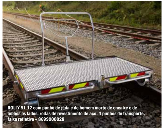
ROLLY 51.12 com punho de guia e de homem morto de encaixe e de ambos os lados, rodas de revestimento de aço, 4 punhos de transporte, faixa refletiva - 8699900028
