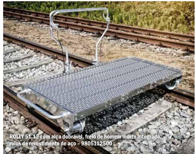
ROLLY 51.12 com alça dobrável, freio de homem morto integrado, rolos de revestimento de aço - 9805112500
