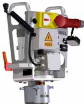
Módulo de rebolo copo com motor elétrico
