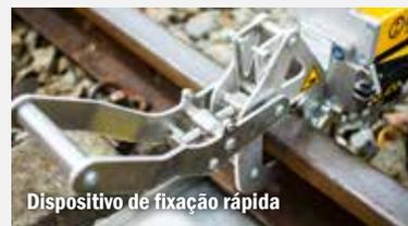
Dispositivo de fixação rápida
