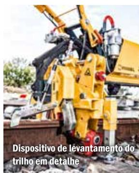
Dispositivo de levantamento do trilho em detalhe
