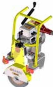
Módulo de rebolo com motor elétrico
