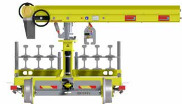
Schemat załadunku z max. 12 szynami na dwóch poziomach
