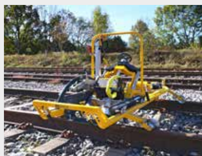
ROGRIND 13.63 Modułowa szlifierka do szyn i rozjazdów
