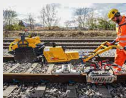
ROCLIP 34.02 Zaciskarka modułowa
