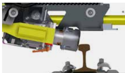
E³-Moduł kamień szlifierski Silnik elektryczny BLDC
