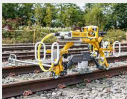
ROGRIND 13.49 E³ Hybrydowa konturowa szlifierka główki szyny
