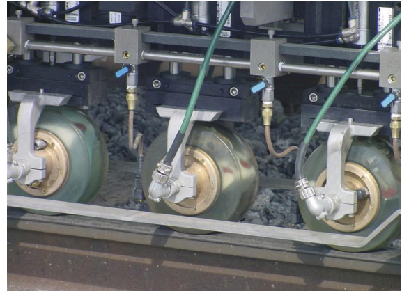
Bild 12: Radbasiertes Ultraschallmesssystem mit drei Prüfrädern (Nordamerikanisches System)
