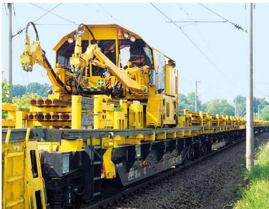
**Abb. 1:** Modulares Schienenladesystem mit Manipulator und Transporteinheit
