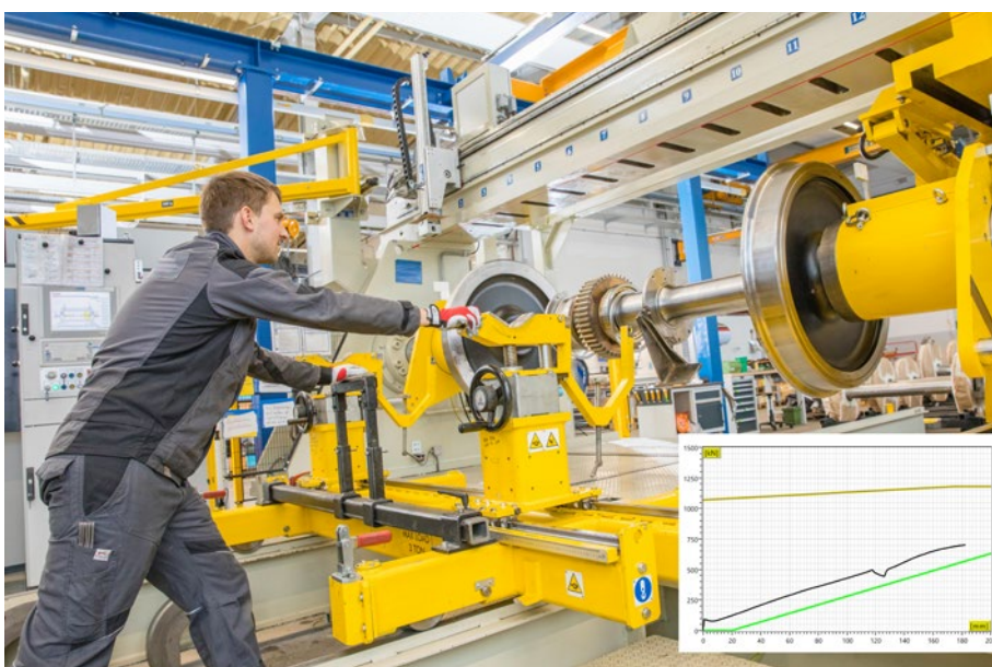
Abb. 3: Die vollautomatische Doppelzylinder-Radsatzpresse protokolliert nach EU Normen.
