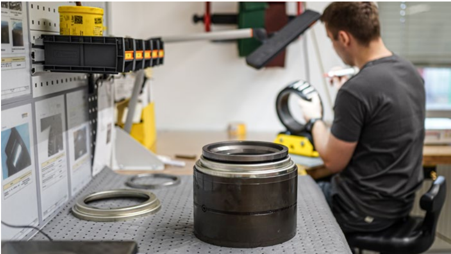
Abb. 5: Das KRД übernimmt die zertifizierte Aufbereitung von Kartuschenlagern.
