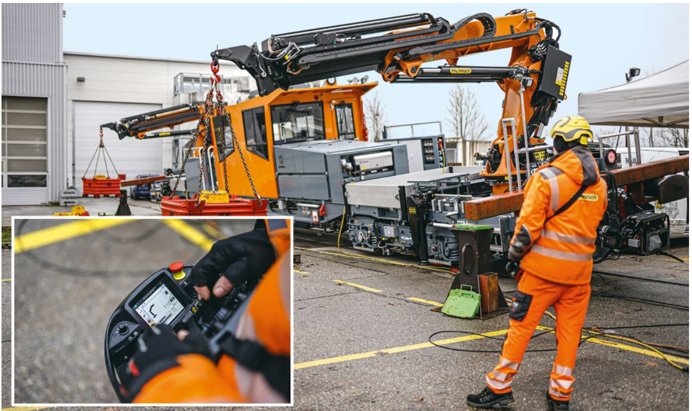
Abb. 3: Standsicherheitstest in Überhöhung mit gleichzeitigem, ferngesteuertem Kranbetrieb.
