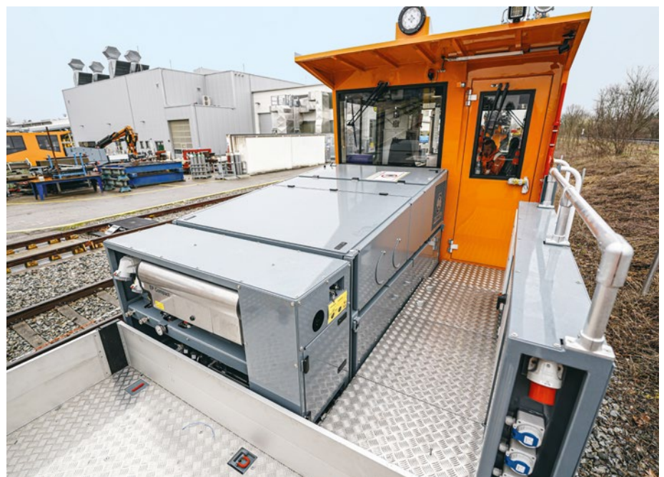
Abb. 2: Das Akkupack ist exakt für 3,5 Stunden Batterie-Arbeitsbetrieb dimensioniert.
