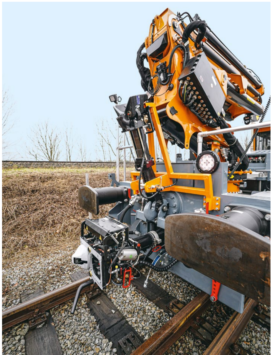
Abb. 6: Für den Betrieb in U- und Vollbahn sind die Fahrzeuge mit Regelzugeinrichtung samt Seitenpuffern, einer zusätzlichen Rangierkupplung und einer pneumatisch absenkbarer SchaKu ausgestattet.
