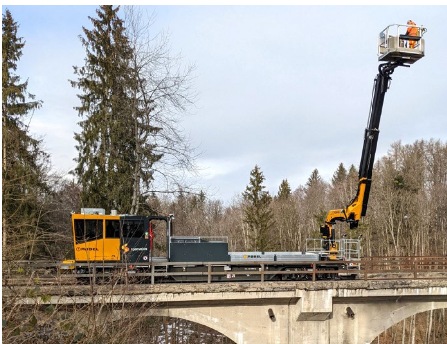
Abb. 7: Robel nutzt die Strecke der Chiemgauer Lokalbahn (hier: Ameranger Viadukt) für Test- und Messfahrten zur Vorbereitung der dynamischen Inbetriebnahme und Zulassung.
