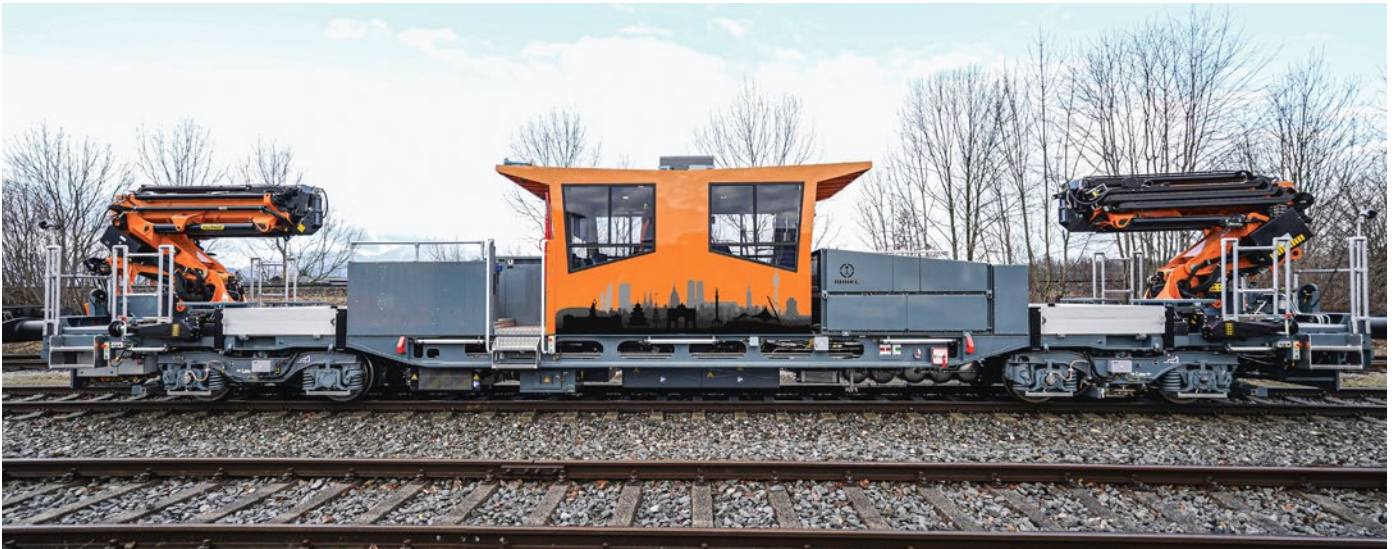
Abb. 1: Der Elektro-Gleiskraftwagen für die Münchner Verkehrsbetriebe ist mit seinem symmetrischen Aufbau für den Zweirichtungsbetrieb ausgelegt.
