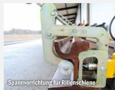
Spannvorrichtung für Rillenschiene
