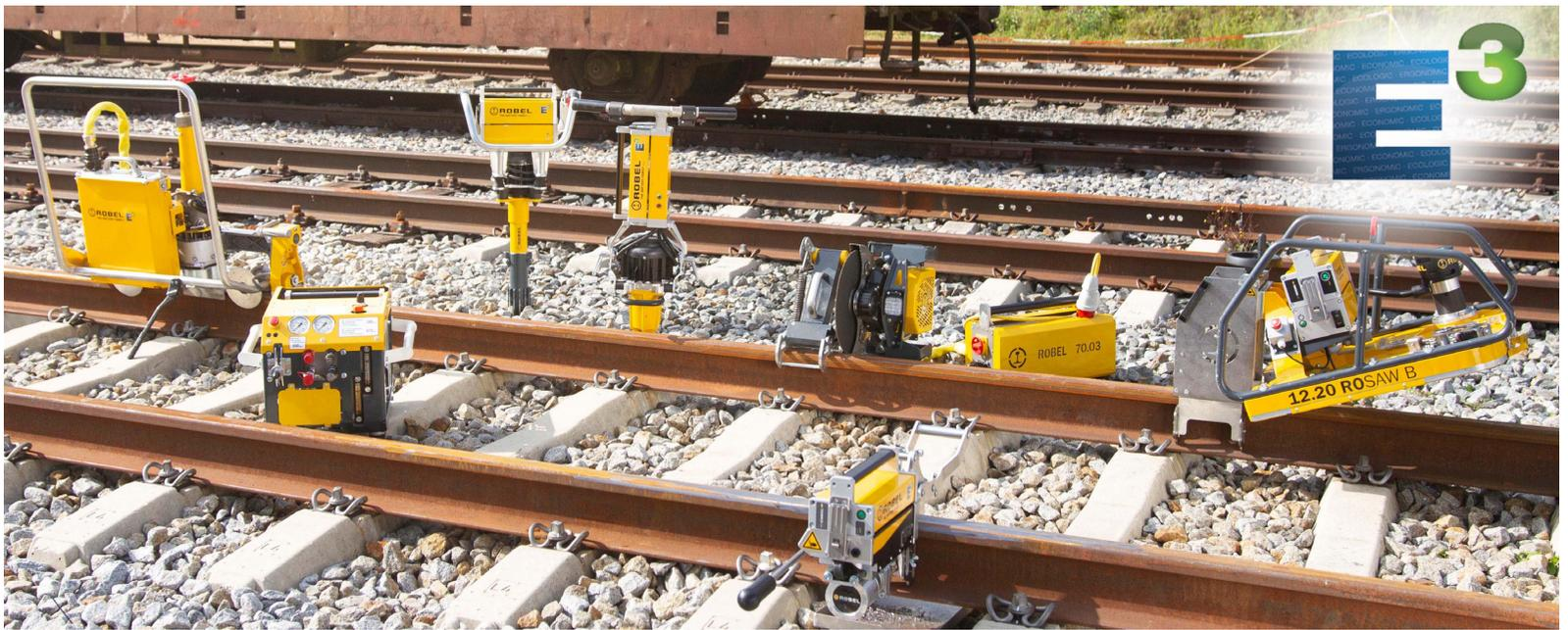
Die E<sup>3</sup>-Maschinen von ROBEL: Schleifmaschine 13.45 MD, Hochdruck-Hydraulikaggregat 76.20, Vertikal-Schwingstopfer 62.20L, Schlagschraubmaschine 30.20, Schienen-Trennschleifgerät 13.90, Schienenbohrmaschine 10.20, Netzteil 70.03, Schienenbandsäge 12.20. Alle werden durch auswechselbare Hochleistungsakkus angetrieben.
