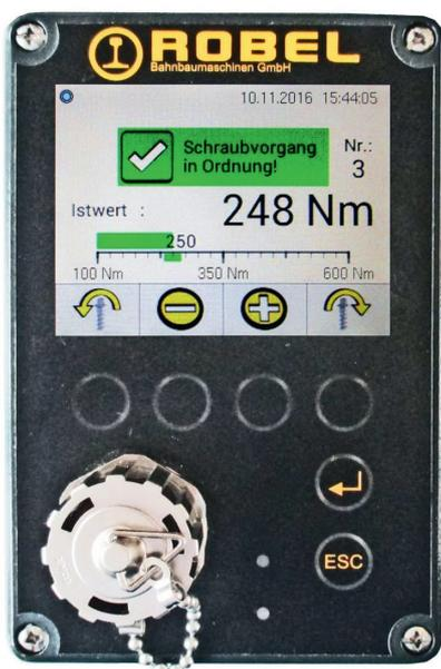
**Abb. 6:** Das Display der SPS zeigt den richtlinienkonformen Abschluss des Schraubvorganges.
