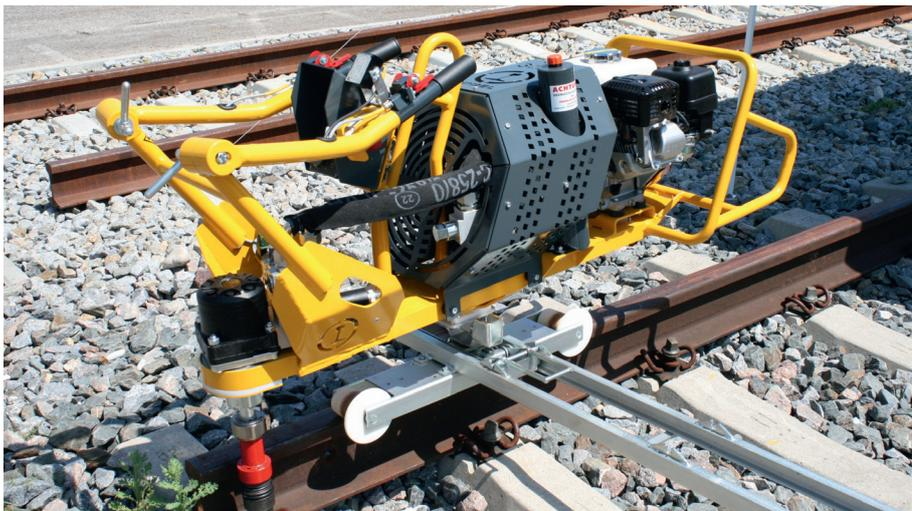
**Abb. 5:** Mit eingeklappten Griffen lässt sich die Schraubmaschine auch bei beengten Platzverhältnissen von vier Personen leicht transportieren.
