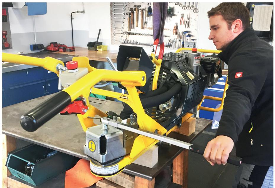
**Abb. 4:** Die jährliche Kalibrierung erfolgt durch geschultes Personal des Bauunternehmers mittels Drehmoment-Messaufsatz.
