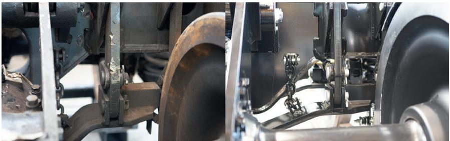
**Abb. 5:** Das defekte Bremsgestänge wird aufgearbeitet, beschädigte Hebel werden durch neue ersetzt und alle Bolzen überprüft und gefettet.
