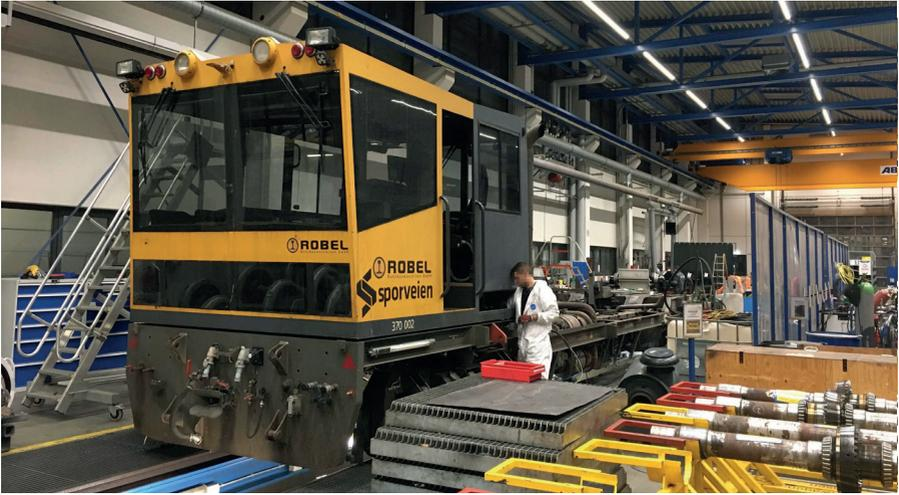
**Abb. 3:** Nach der Eingangsuntersuchung beginnt die vollständige Demontage des Gleiskraftwagens.
