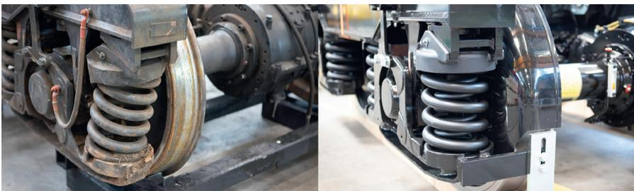
**Abb. 10:** Die Primärfederung wird normgerecht instandgesetzt, die abgefahrene Radscheibe durch eine neue ersetzt.
