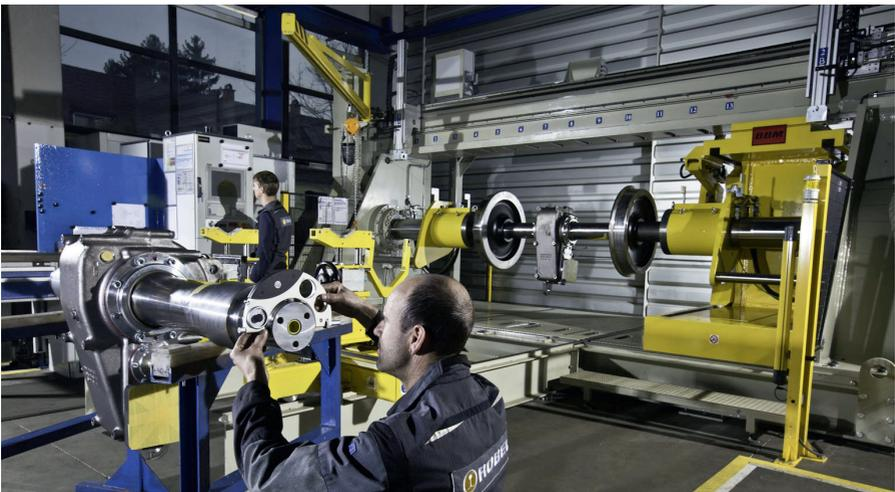
**Abb. 8:** Doppelzylinderachspresse für automatisches Auf- und Abziehen von Rädern und Bremscheiben inkl. digitaler Überwachung und Protokollierung
