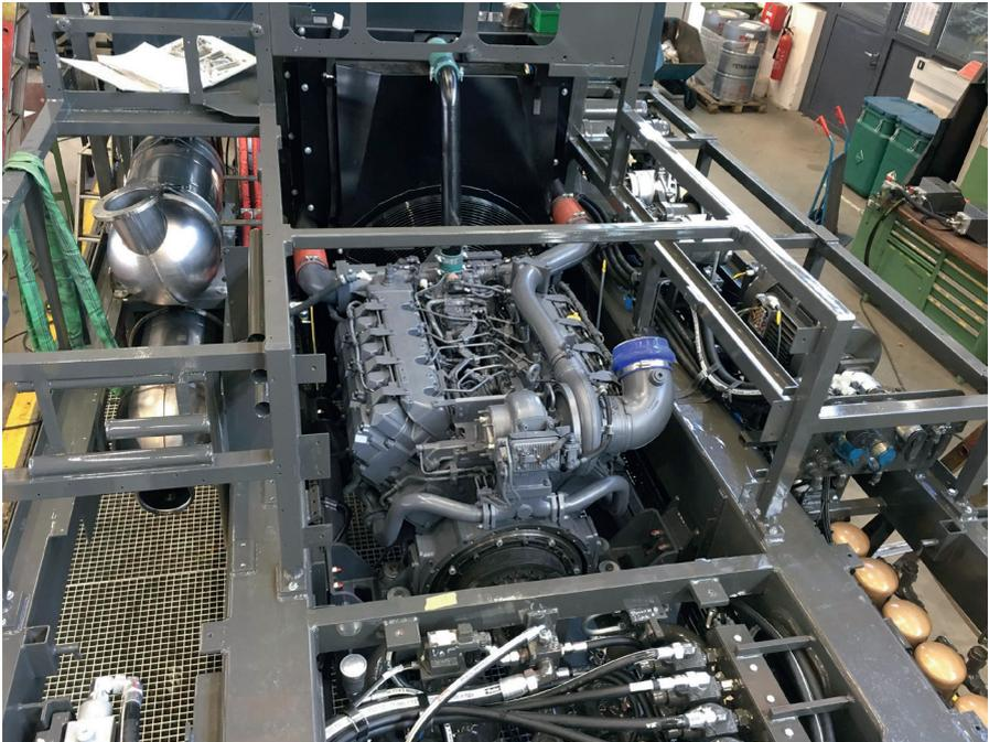
**Abb. 12:** Durch den Einbau eines neuen Motors mit SCR-Anlage arbeitet das Fahrzeug nach dem Retrofit innerhalb der aktuell gültigen Abgasgrenzwerte.
