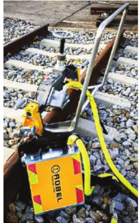
Abbildung 2: Die Schleifmaschine von Robel mit einem 2 kWh Akkuantrieb.
