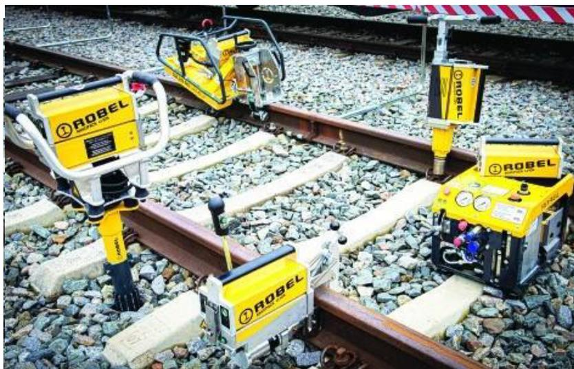
Abbildung 1: Robels „Akku-Familie“, bestehend aus Vertikalschwingstopfer, Schienenbandsäge, Schienenbohrmaschine, Schlagschraubmaschine und Hochdruck-Hydraulikaggregat, wird von einem austauschbaren Hochleistungsakku angetrieben.
