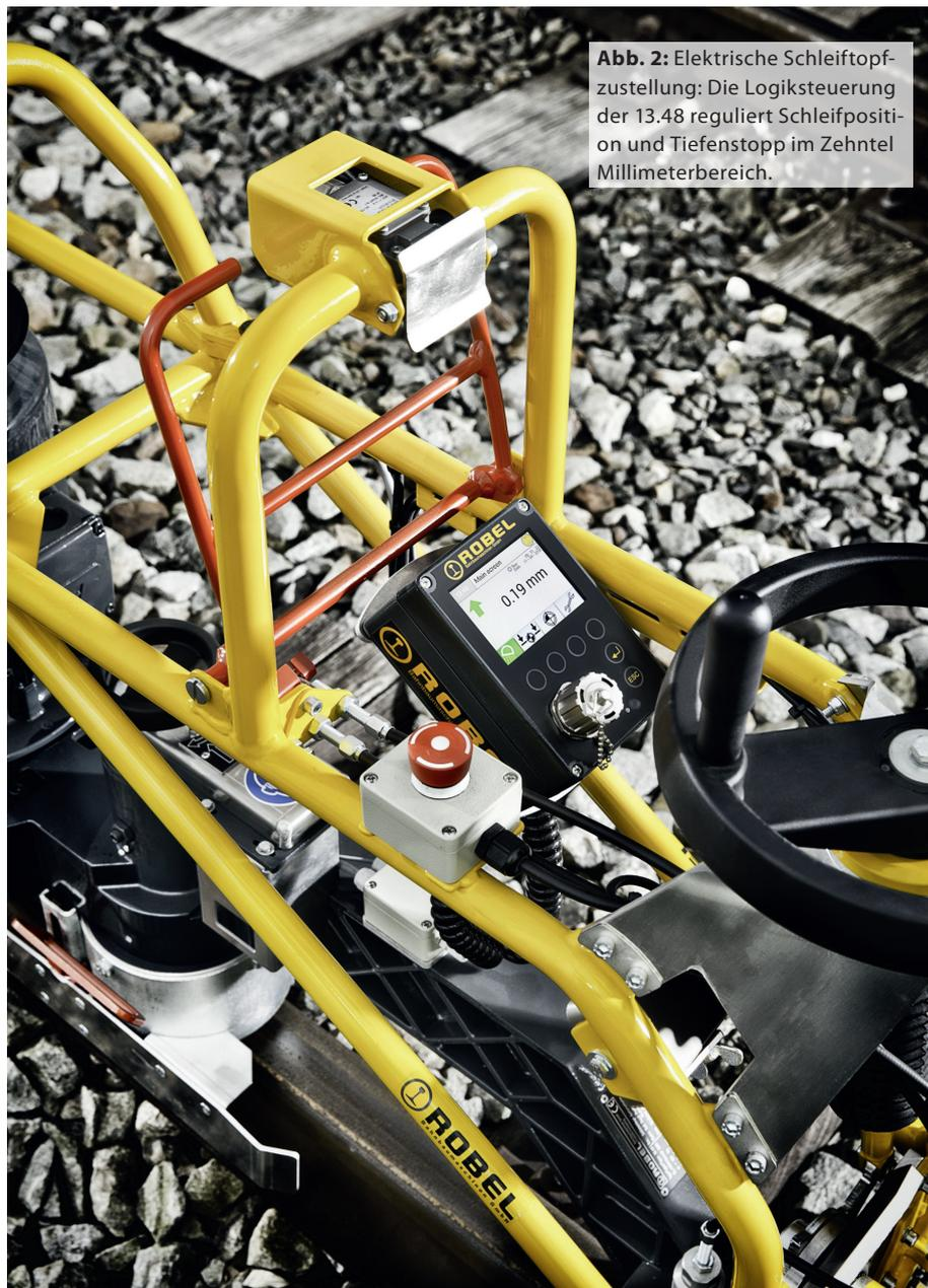
**Abb. 2:** Elektrische Schleiftopf-zustellung: Die Logiksteuerung der 13.48 reguliert Schleifposition und Tiefenstopp im Zehntel Millimeterbereich.
