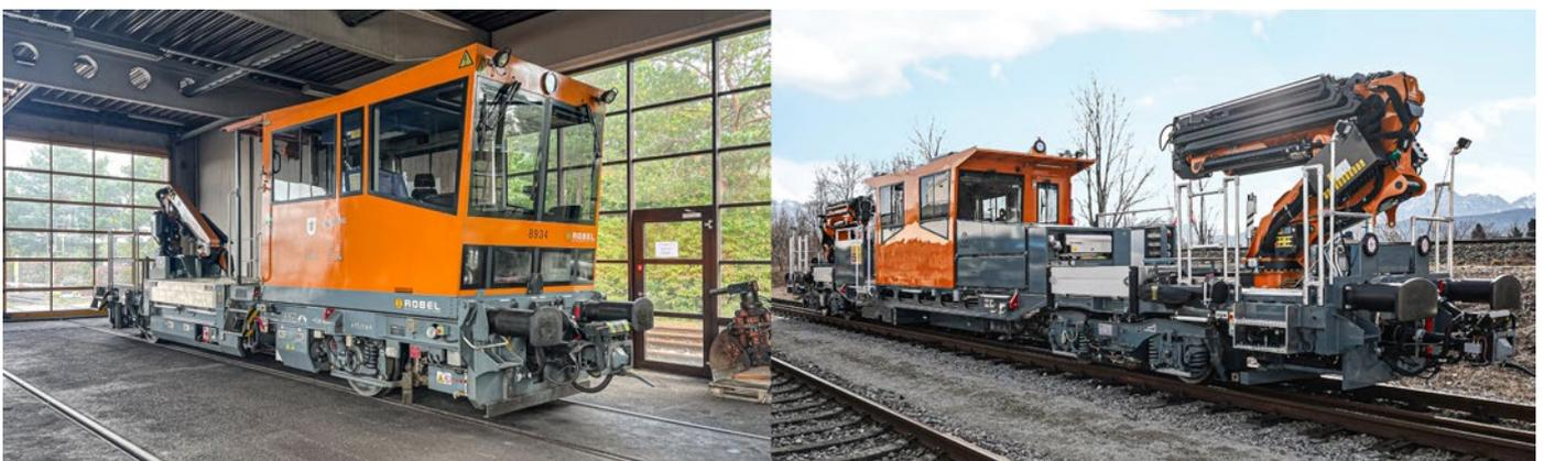
**Abb. 3:** Von einem zu zwei Kranen: Der bestehende Gleiskraftwagenfuhrpark wird ab 2024 durch zehn dreiachsige Hybrid-Gleiskraftwagen ergänzt
