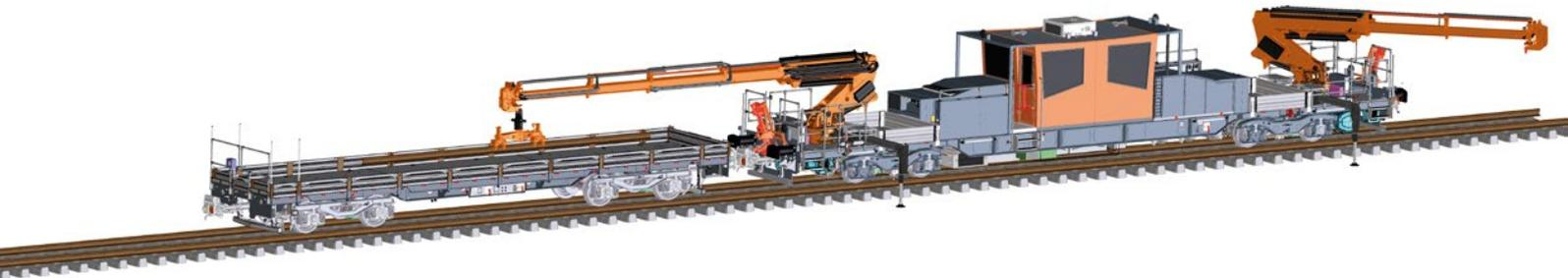
**Abb. 4:** Da im Münchner U-Bahn-Netz keine Wendemöglichkeit besteht, sind alle Einheiten mit je einem Kran an beiden Fahrzeugfronten sowie beidseitiger Ladefläche auf Bahnsteigniveau für den Zweirichtungsbetrieb ausgelegt Quelle: Robel
