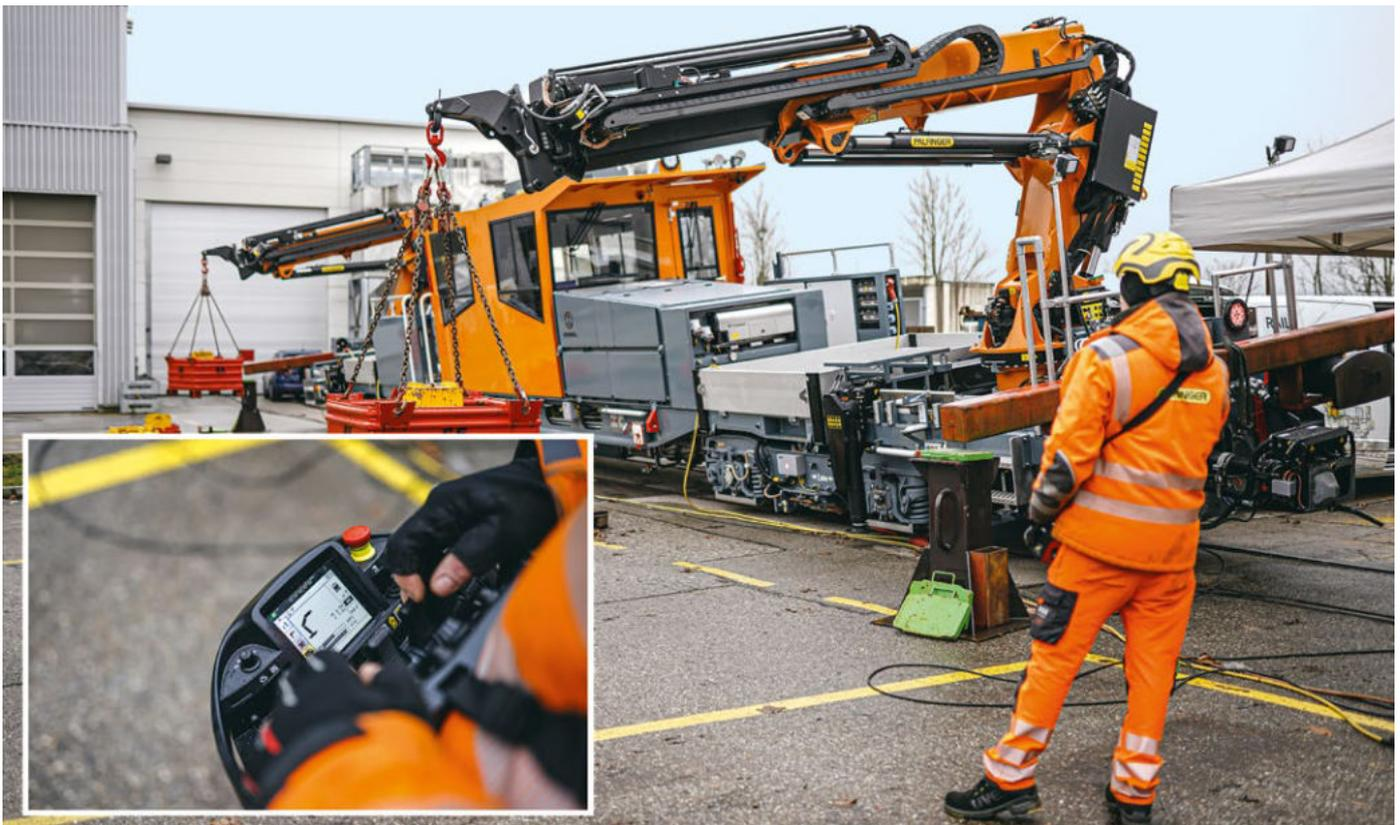
Abb. 3: Standsicherheitstest in Überhöhung mit gleichzeitigem, ferngesteuertem Kranbetrieb.
