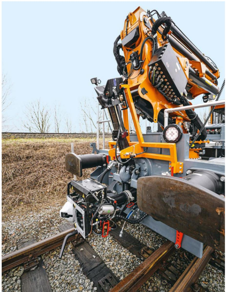
**Abb. 6:** Für den Betrieb in U- und Vollbahn sind die Fahrzeuge mit Regelzugeinrichtung samt Seitenpuffern, einer zusätzlichen Rangierkupplung und einer pneumatisch absenkbaren SchaKu ausgestattet.
